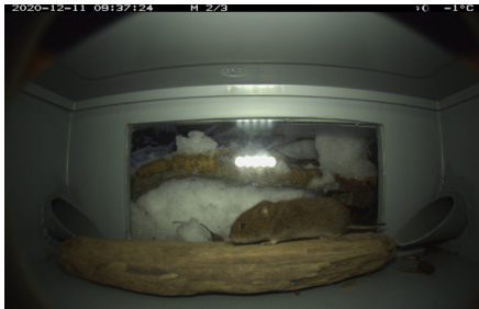
Abbildung 2: Eines der ersten Fotos der ersten Testrunde mit der MiniMammalCamBox. Abgebildet sind eine Rötelmaus ( Myodes glareolus ) sowie die störende Reflexion des Blitzes im Glas gegenüber der Fotofalle.
