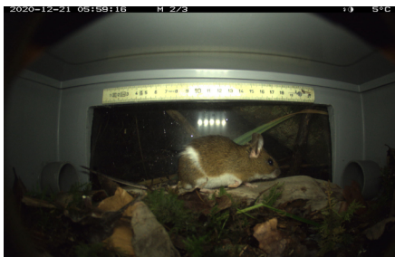
Abbildung 3: Erste Verbesserungsschritte der MiniMammalCamBox beinhalteten das Anwinkeln der Glasscheibe, das Anbringen eines Massstabes über dem Fenster sowie das Ausbringen von Laub in der Box für ein natürlicheres Erscheinungsbild. Hier wurde eine Gelbhalsmaus ( Apodemus flavicollis ) mit Pigmentfehler im Hüftbereich «eingefangen». Trotz Anwinkeln des Glases kam es zu unschönen Reflexionen.
